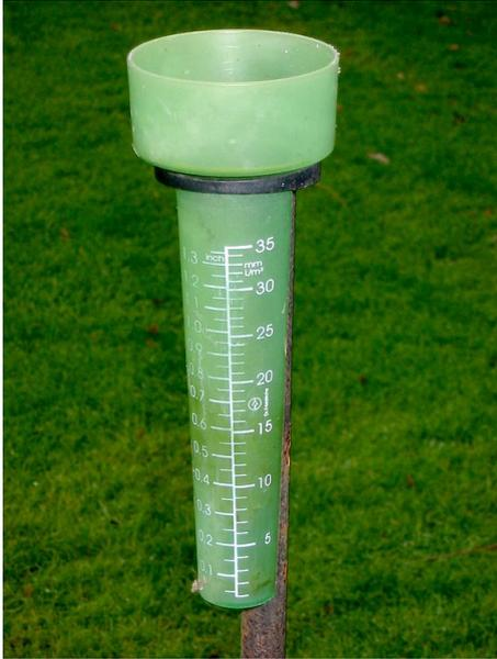
Un pluviomètre permet de mesurer la quantité de pluie tombée à un endroit précis pendant un certain temps.
