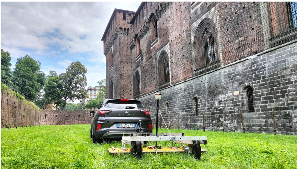
Une voiture tracte le géoradar pour explorer les sols sans creuser. © Politecnico di Milano
